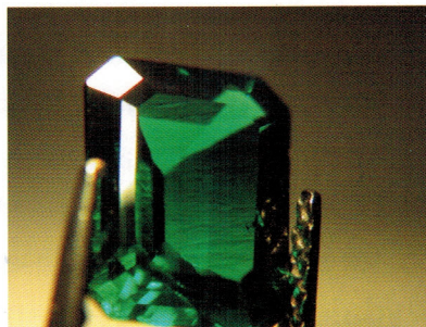
Diagnostyczne zakłócenia przejrzystości w syntetycznych szmaragdach Tairus. Powiększenie 20x.
